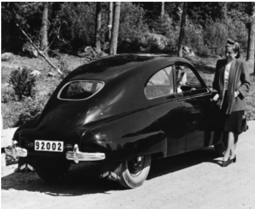
SAAB 92 med gångjärn i bakkanten på dörrarna och ingen baklucka.
