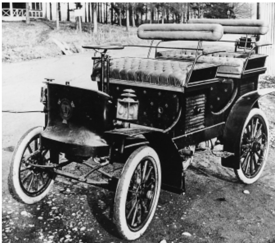
"Scania-Automobil, lätt promenadvagn för fyra personer 6 hk. 2 hastigheter fram, 1 back" står det på ritningen från 1902. I mitten, längst ner syns motorn. Kraften överförs med kedjor till bakaxelns två kardanaxlar.
